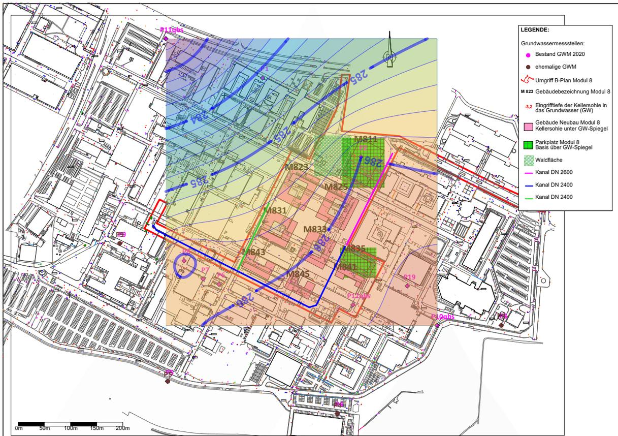
Abbildung 5: Grundwassergleichenplan Hochwasser Juni 2013
