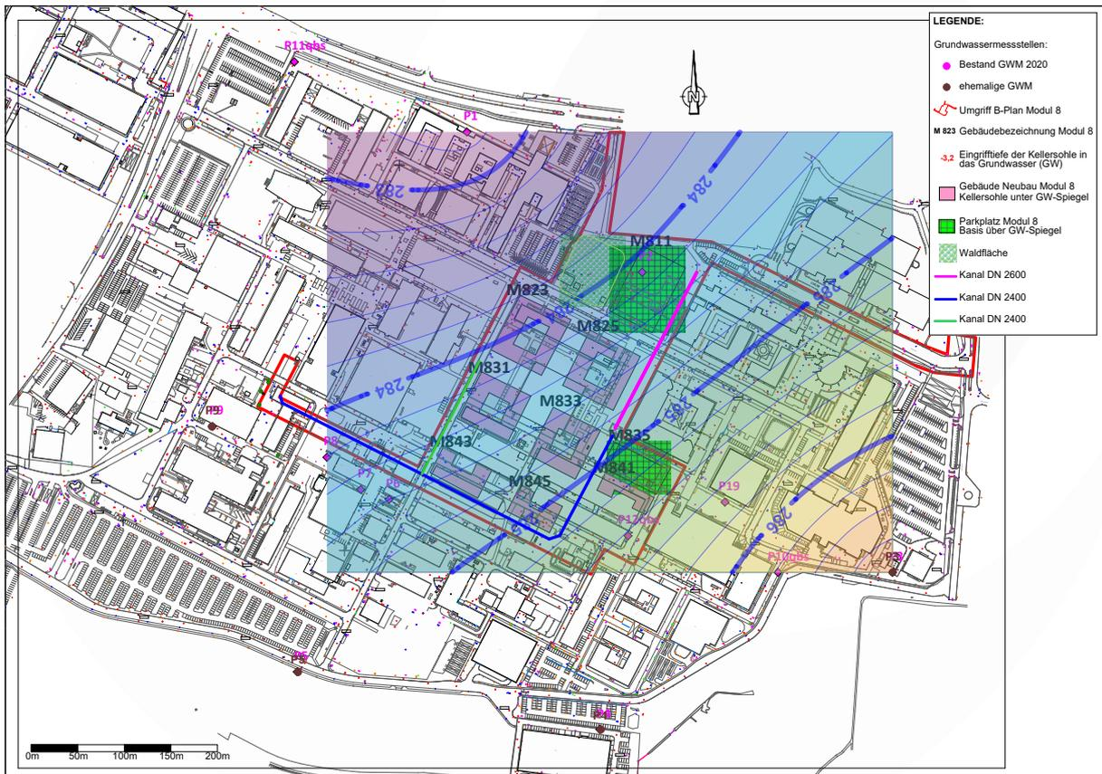
Abbildung 6: Grundwassergleichenplan Niedrigwasser Oktober 2003
